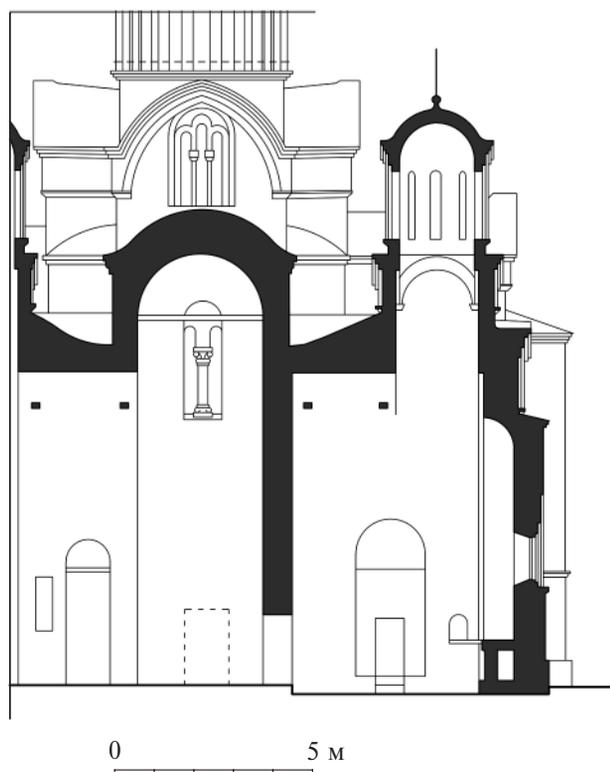
**Рис. 5.** Разрез южной капеллы ц. Успения в Грачанице с показанием престола.
